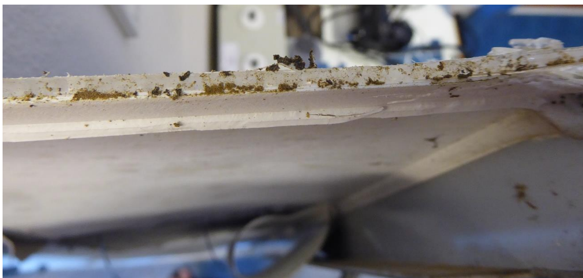
Obr. 73 Netěsnosti mezi rámem a hranou skla modulu
